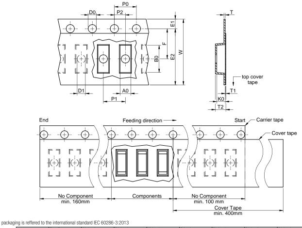
W (mm) T1 (mm) P0 (mm) P1 (mm) A0 (mm) B0 (mm) T (mm) Гаре Туре Tolerance +0,3/-0,1 ref +0.1+0.1typ. tvp. ref Value 1,88 3,50 8,00 0,25 0,10 4,00 4,00 1a P2 (mm) D0 (mm) E1 (mm) E2 (mm) F (mm) Material Qty. (pcs.) Tolerance ±0,05 +0,1/-0,0 ±0,1 min. ±0,05 1.50 1.75 Value 2.00 6 25 3.50 Polystyrene
