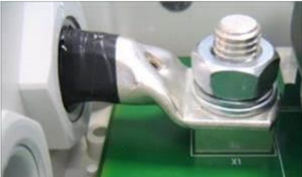
Vibrationsfeste Stromversorgung dank eingepresstem Hochstromkontakt
