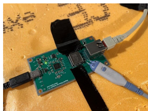
Abbildung 6: Oben: Leitungscodes Ethernet-Signal zwischen Übertrager und RJ45 Buchse; Unten: Aufbau der Messung
