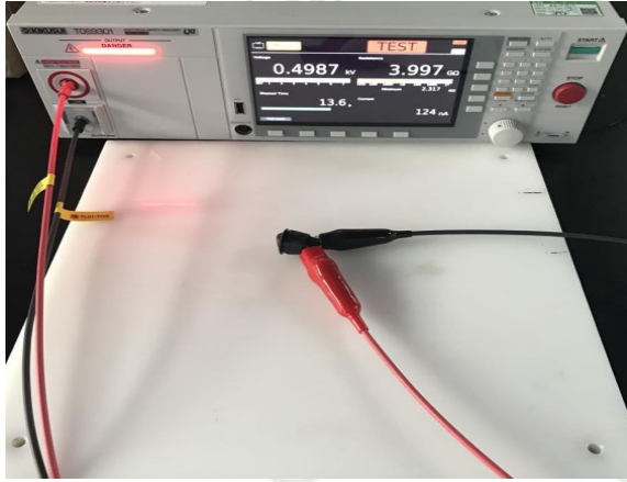
绝缘电阻测试中
