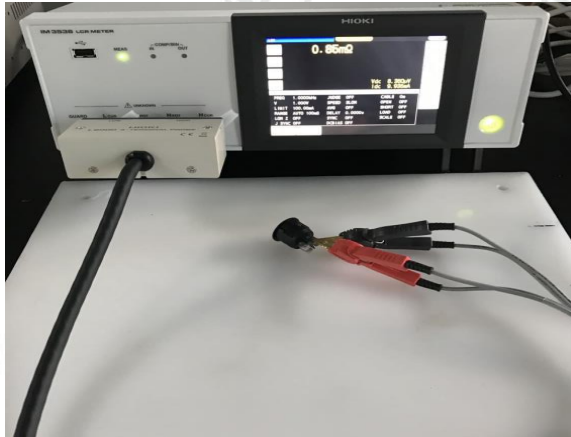
接触电阻试验中 Contact resistance test
