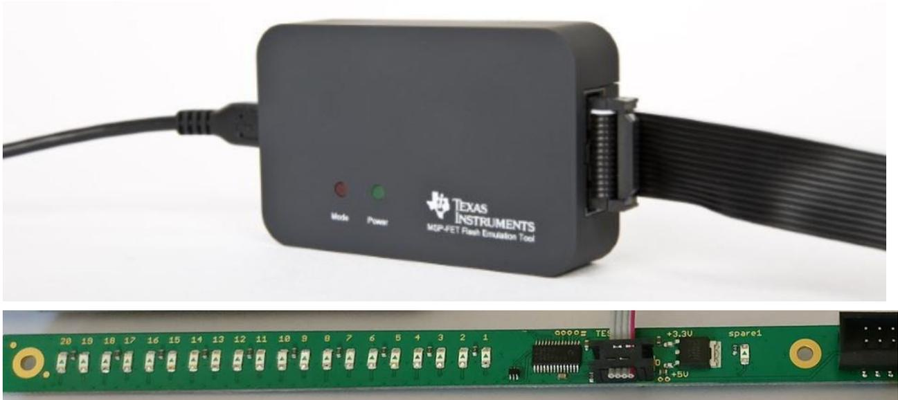
Bild 5: Der REDFIT IDC SKEDD in der Debug-Anwendung
