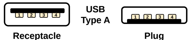
Abb. 1: Pinbelegung der USB Schnittstelle, Buchse und Stecker Type A
