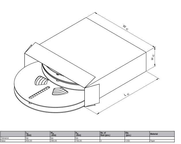
No. of Qty. (pcs.) L<sub>C</sub> (mm) (mm) н<sub>с</sub> (mm) Material Inner Carton (pcs.) Tolerance typ. tvp typ. Value 340,00 425,00 412.00 3600 Paper
