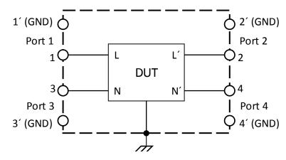
Network Analyzer: Keysight E5080A or equivalent
