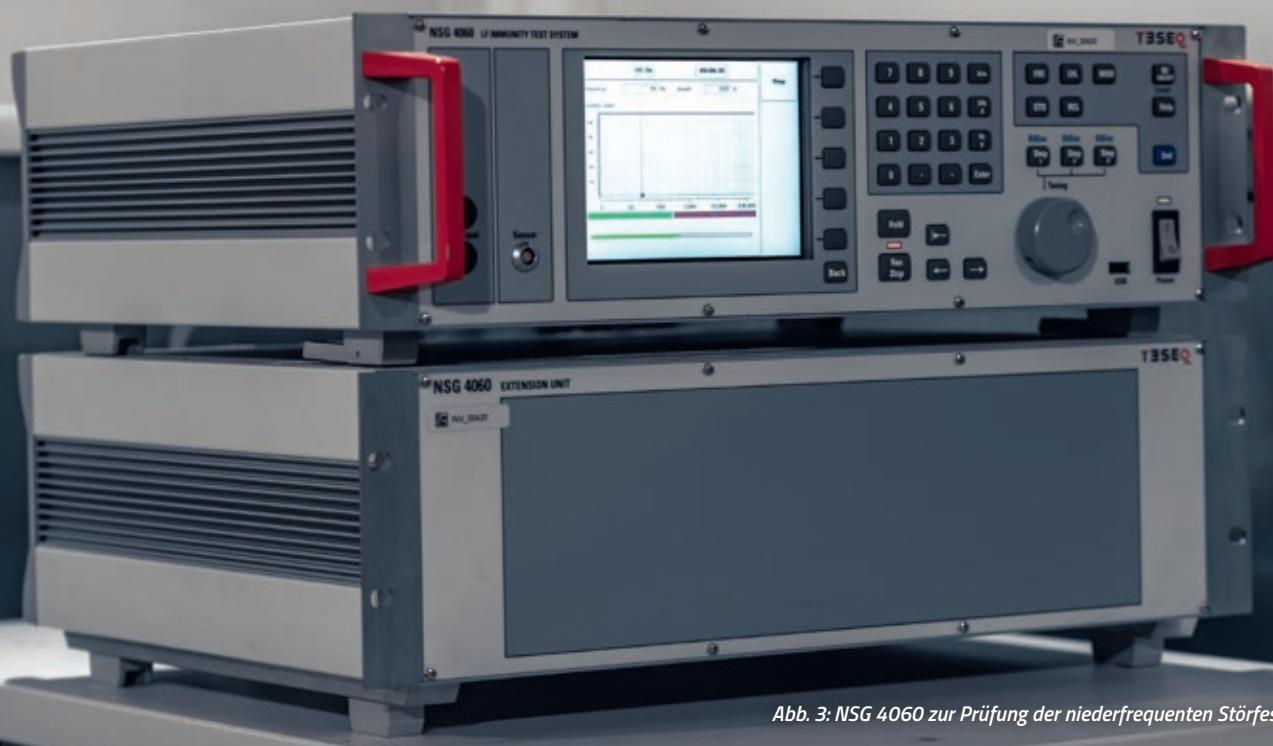
Abb. 3: NSG 4060 zur Prüfung der niederfrequenten Störfestigkeit
