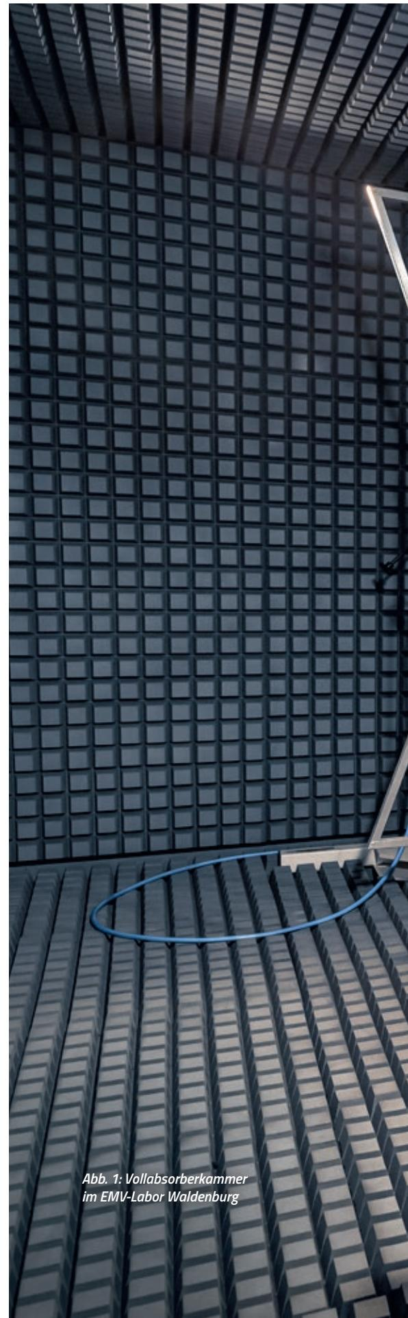
*Abb. 1: Vollabsorberkammer
