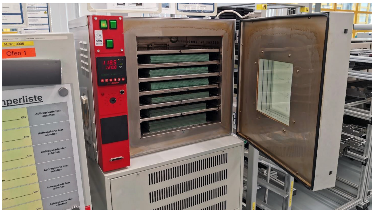
Abb.34: Serienprozess Trocknen Stufe 1 im Umluft-Trockenschrank bei BASLER [12]
