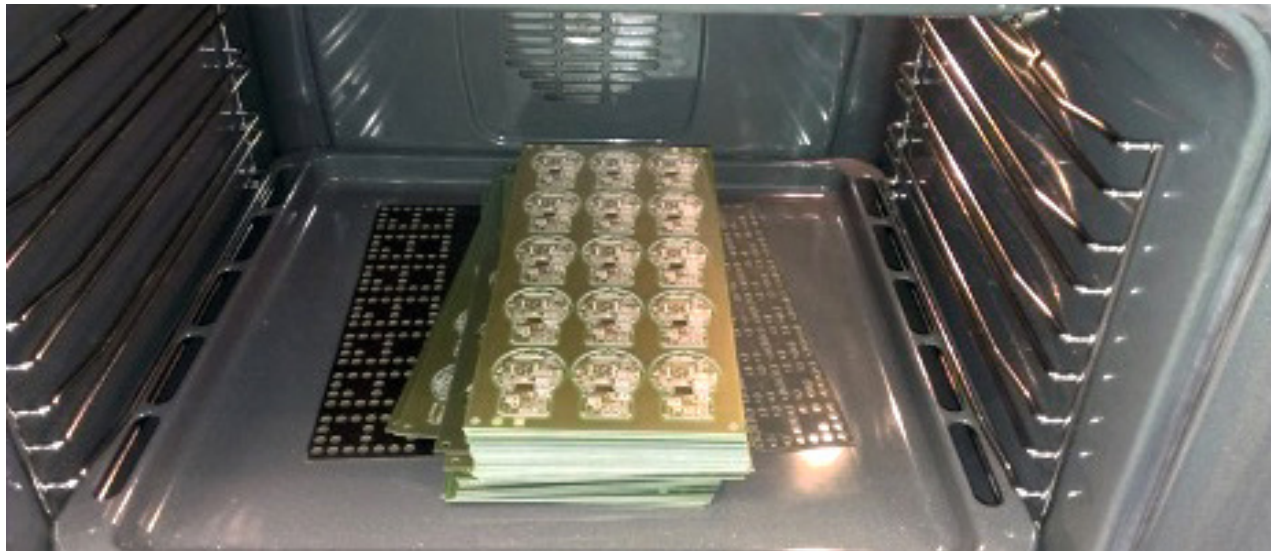
Abb.36: Zwei gravierende Fehler: Eindeutig zu dicker Stapel starrflexibler PCBs und nicht geeigneter Backofen
