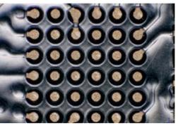
links BGA-Pitch 0,40 mm mit Microvia-in-Pad, plane Oberfläche
