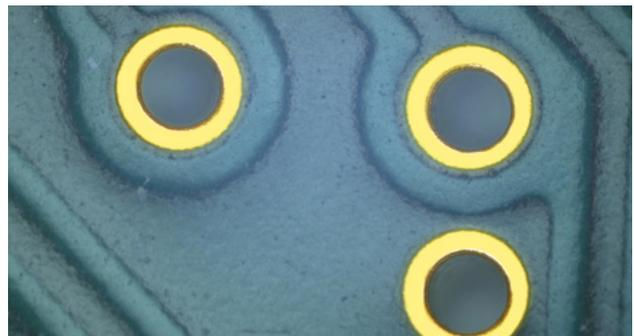
Via-Bohrungen mit Lötstopp teilweise überdeckt
