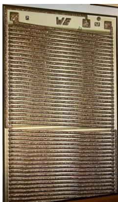
Abbildung 5: Transformator mit zwei Ausgängen für die GaN-Gate-Ansteuerung.
