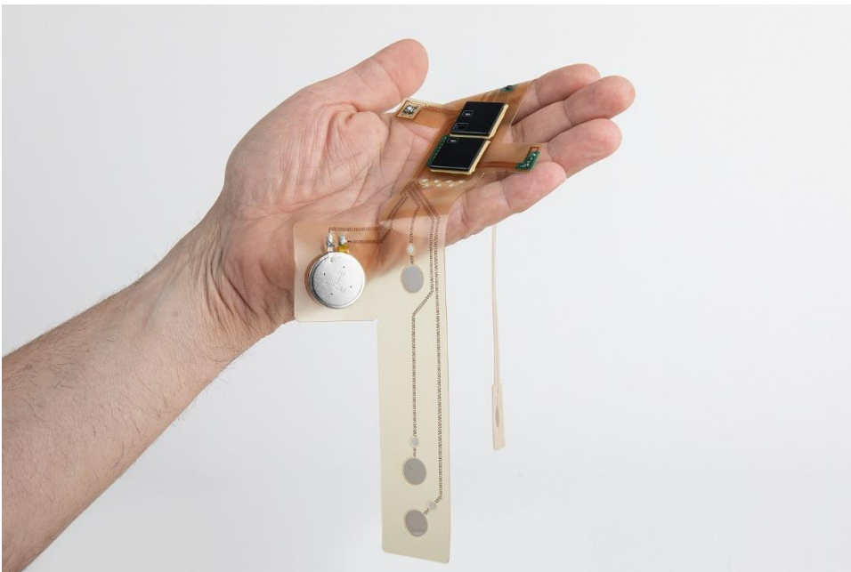
Bild 1: Dehnbare Leiterplatte mit integrierter Elektronik und gedruckten Elektroden – ein ausgesprochen nachgiebiges und biokompatibles Substrat für Smart Patches. (Quelle: Würth Elektronik Circuit Board Technology)
