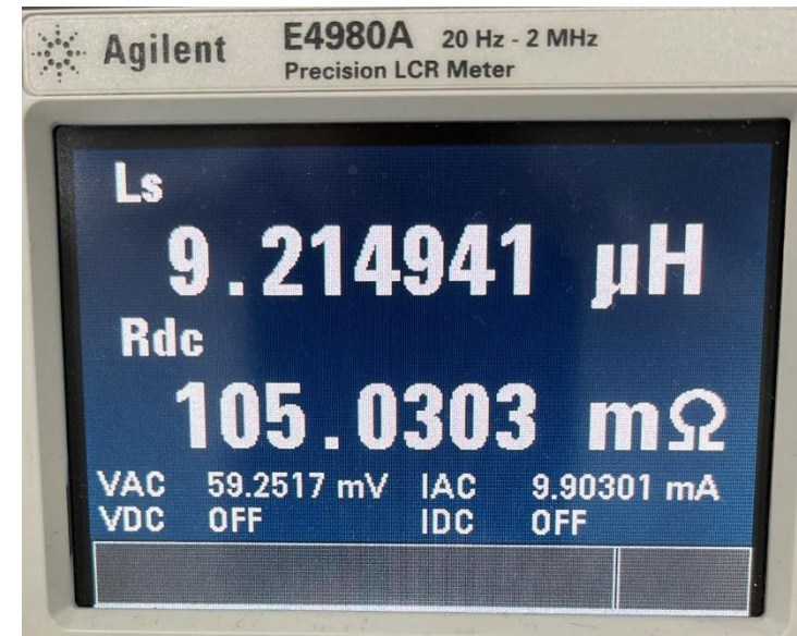
b. Induktivität mit Beschädigung
