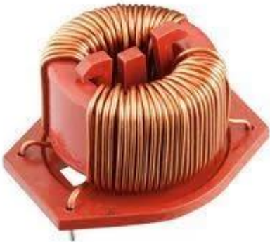
Wurth Elektronik 744834310 Common Mode Choke, 0.01H, 3A
