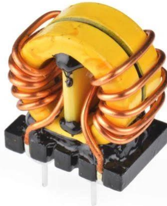
Wurth Elektronik 100 \mu H 14A Common Mode Choke 6 m \Omega 250 V ac 744844101
