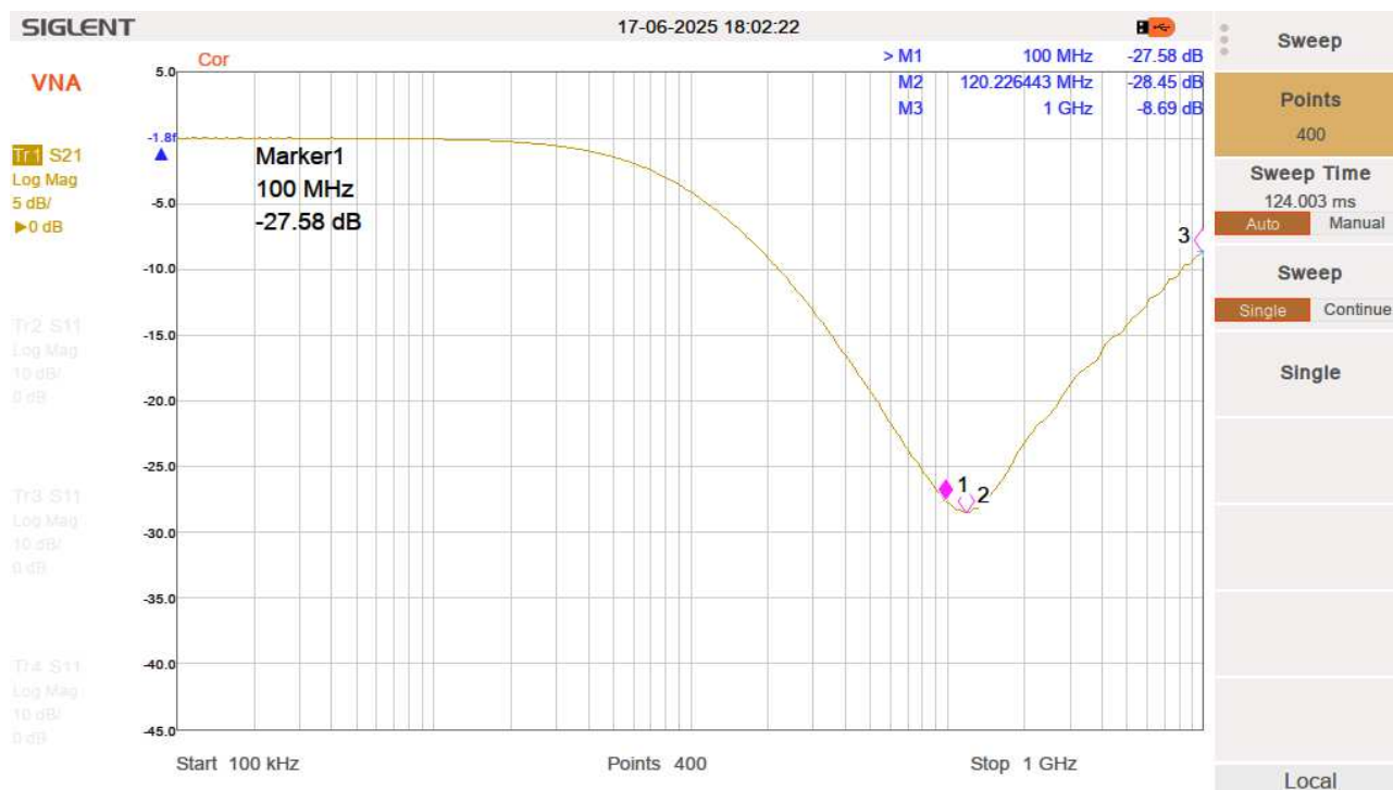
25061703: Einfügungsdämpfung im 50- \Omega -System für ein Bauteil des Typs WE 742792693: SMD-Ferrit mit 2,2 k \Omega @ 100 MHz
