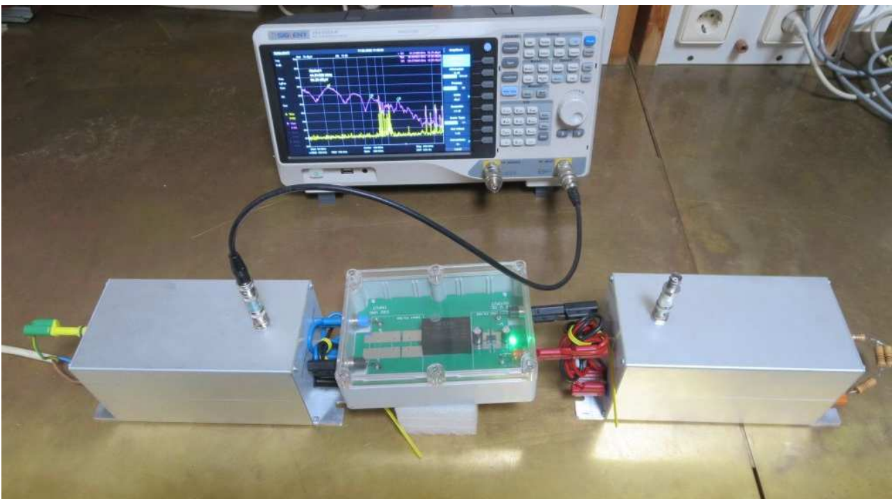
Foto 5434: Links: Netzteil an 230 V, 50 Hz über CDN M2, Rechts: Last 12 V, 480 mA über CDN M4 (zweites M2 war nicht verfügbar)
