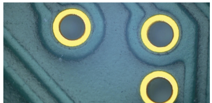
Via-Bohrungen mit Lötstopp teilweise überdeckt
