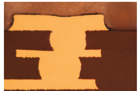
Microvia gefüllt mit Kupfer (nicht in IPC-4761 beschrieben)
