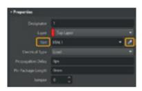
Im Feld "Net" wird das zugeordnete Netz angezeigt. Mit dem Pipettensymbol kann interaktiv ein neues Netz zugewiesen werden. Ein Klick auf "Net" öffnet die Eigenschaften des Netzes. Im Feld "Propagation Delay" kann die Signalverzögerung für das Pad eingetragen werden. Im Feld "Pin Package Length" kann die interne Länge der Verbindung zwischen dem Pad und dem Chip an-
