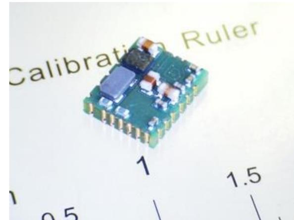
Embedded Die –  $5,5 \times 4,5 \text{ mm}^2 = 24,75 \text{ mm}^2$
