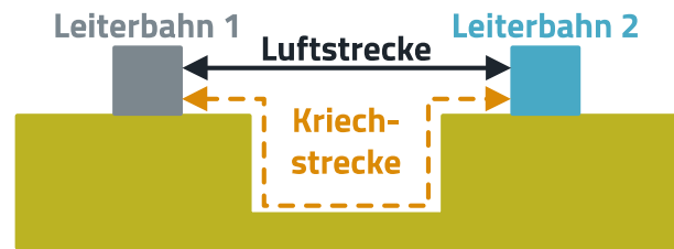
Abbildung 2: Darstellung von Luft- und Kriechstrecke.
