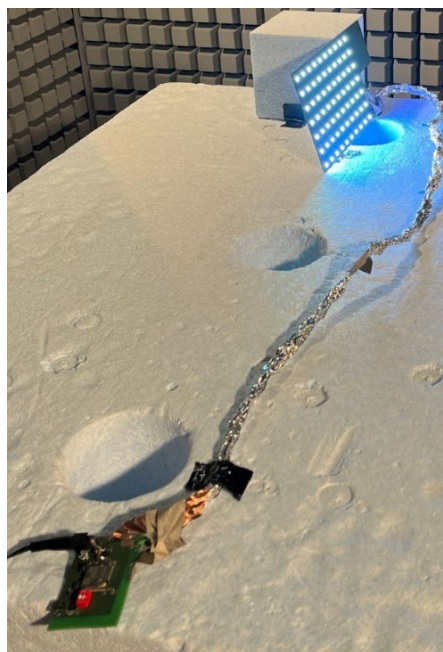
Abbildung 21: Kabel zwischen MCU-Leiterplatte und LED-Feld, geschirmt mit Aluminiumfolie.
