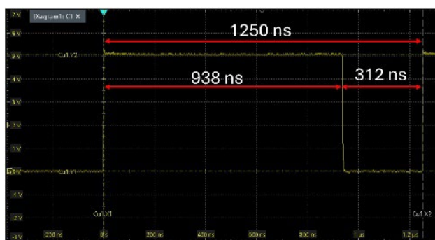
Abbildung 9: Gemessene Spannung für digitales Bit 0 (oben) und digitales Bit 1 (unten) zur Steuerung der ICLED.
