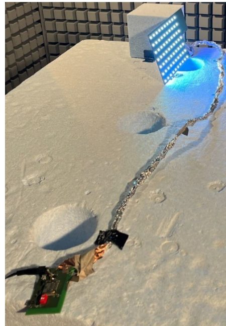
Abbildung 21: Kabel zwischen MCU-Leiterplatte und LED-Feld, geschirmt mit Aluminiumfolie.
