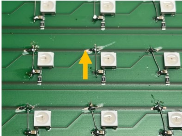
Abbildung 8: Korrektur mit einer Leitung an jedem Entkopplungskondensator.
