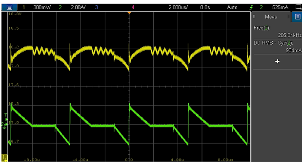
Abbildung 28: Gemessene Signalverläufe für C_{AC} des DCM-SEPIC [ V_{C_{AC}} (I), I_{C_{AC}} (I)]
