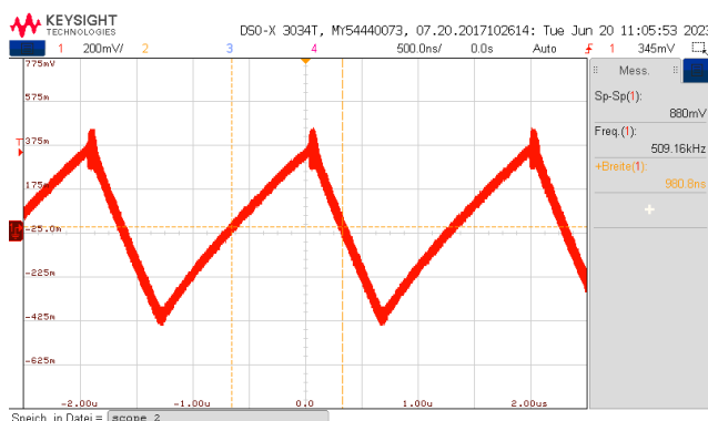
Abbildung 8: Screenshot des Ripplestroms des unbeschädigten (links) und des beschädigten Bauteils (rechts)
