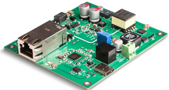
Abbildung 9: GB-Ethernet-USB-Adapters mit PoE
