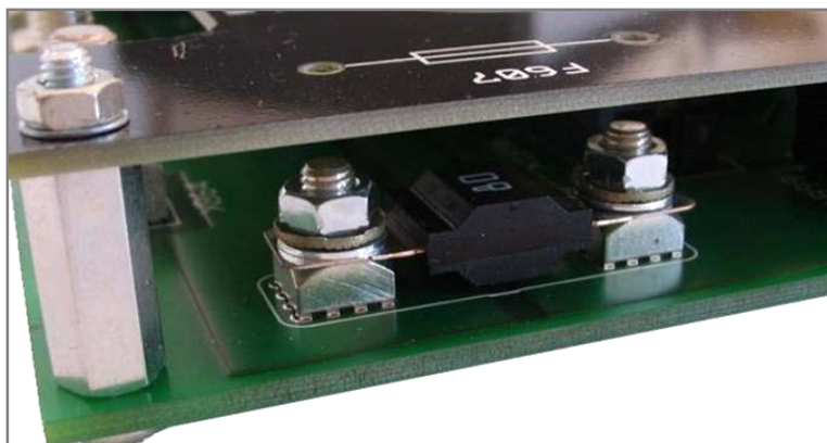
Möglichkeit zur Anbringung einer Sicherung
