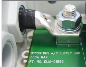
REDCUBE PRESS-FIT für Ströme bis 300 A
