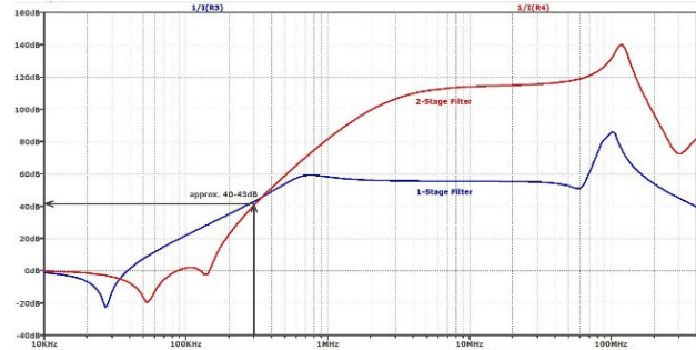
Abbildung 17: LTspice Simulation der CM Einfügedämpfung, 10 kHz bis 400 MHz; Blau = 1-Stufen-Filter; Rot = 2-Stufen-Filter
