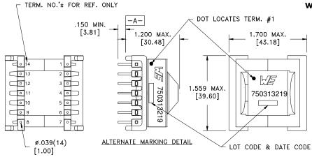
PART MUST INSERT FULLY TO SURFACE A IN RECOMMENDED GRID
