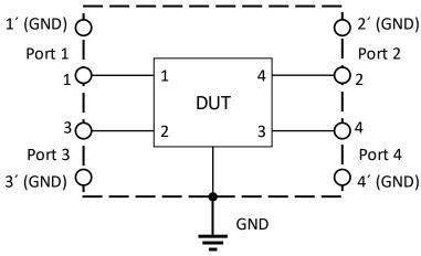
Network Analyzer: Keysight E5080A or equivalent
