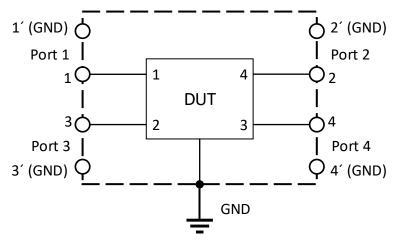
Network Analyzer: Keysight E5080A or equivalent
