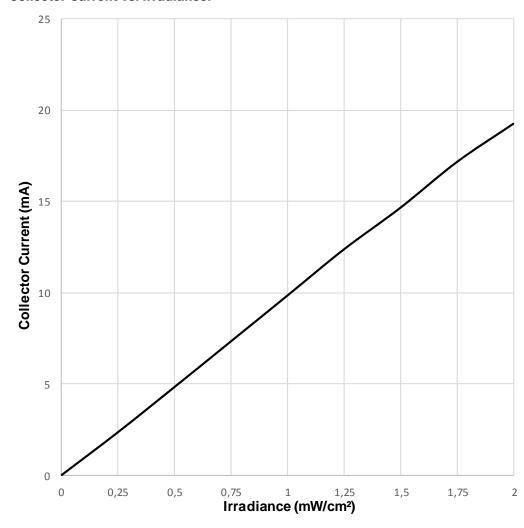
Testcondition: Ee= 0,5 mW/ cm<sup>2</sup>; VCE=5V
