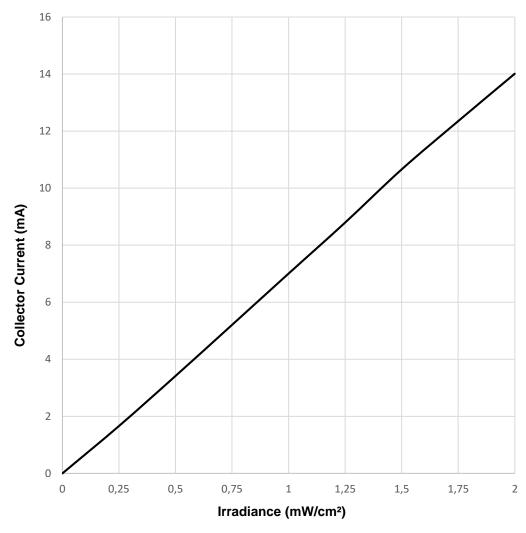
Testcondition: Ee= 0,5 mW/ cm<sup>2</sup>; VCE=5V
