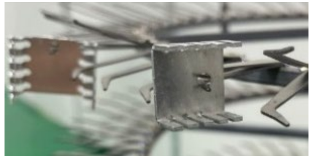
Abbildung 11: Beispiel für Halterungen beim Eloxier-Prozess für die Kühlkörper der WE-HTO-Serie.
