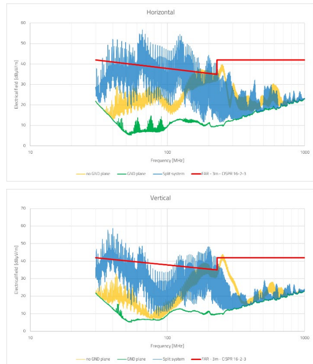
Abbildung 19: EMV-Prüfergebnisse für Störabstrahlungen: MCU und ICLEDs auf derselben Platine (grün und gelb) und Konfiguration mit zwei Platinen (blau).
