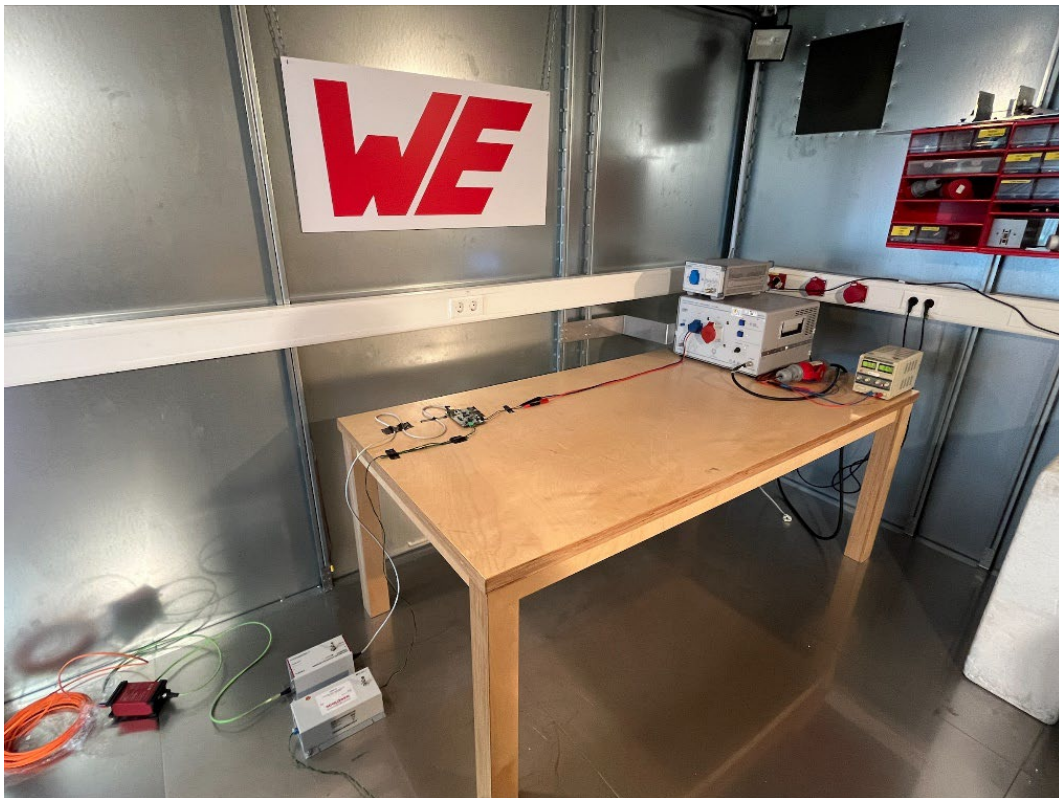
Abbildung 10: Messung der leitungsgeführten Störaussendung am PSE-Board des SPoE Reference-Designs.
