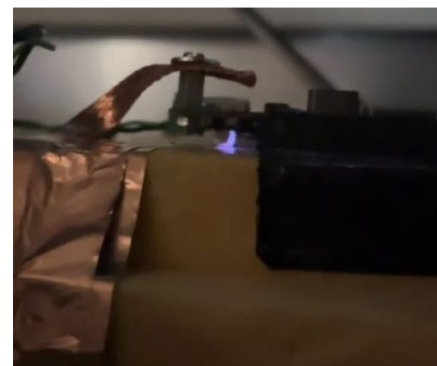
Abbildung 25: Die Gas-Discharge-Tube (GDT) leitet einen mit der kapazitiven Koppelzange eingekoppelten Burst auf der SPoE-Schnittstelle, die mit ungeschirmten Twisted-Pair-Leitung betrieben wird, ab.
