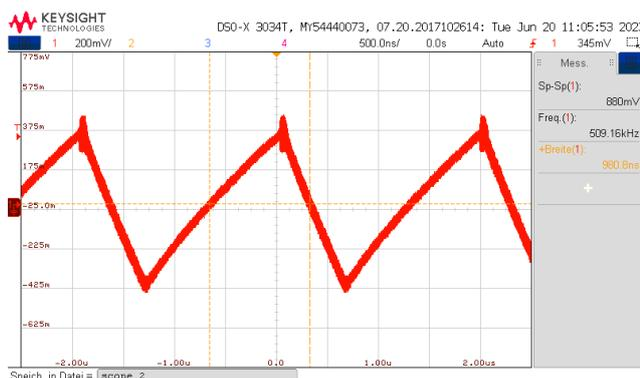
Die Anwendung funktioniert nach wie vor: Die Spannung wird von 18 V auf 5 V abgesenkt. Aber welchen Einfluss hat dieser Widerstand, der im Schaltplan und im Ripplestromdiagramm zu sehen ist?
