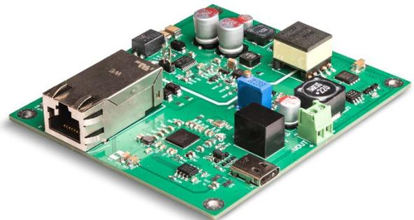
Abbildung 9: GB-Ethernet-USB-Adapters mit PoE
