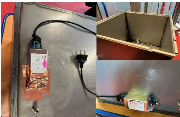
Abbildung 9: Schirmbox zur Reduktion der Störungen des Zusatzequipments. Die 230 Vac Versorgung wird mittels zweistufigem Filter an der Durchführung in die Box gefiltert. Geschirmte Leitungen werden an der Schirmdurchführung an Gehäusemasse angeschlossen, der Deckel wird mittels HF-Dichtungen abgedichtet, um elektromagnetische Abstrahlung über Öffnungen zu verhindern
