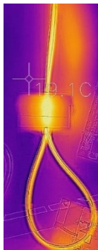
Abbildung 4: TBL-Überstromprüfung bei einer Umgebungstemperatur von 19,1°C
