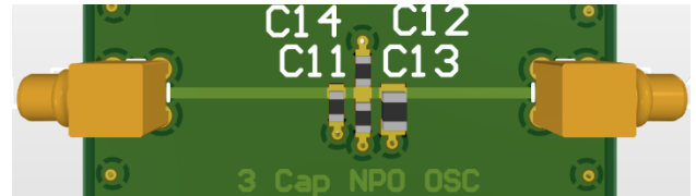
Abbildung 8: Messkanal mit drei verschiedenen Kapazitätswerten, aber gleichem Dielektrikum. Der vierte MLCC zwischen den Beschriftungen, wurde bei den Tests nicht bestückt.
