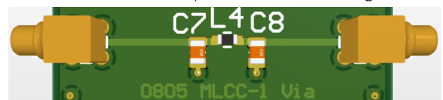
Abbildung 5: Messkanal mit 0805-MLCC und je einer Via am GND-Pad
