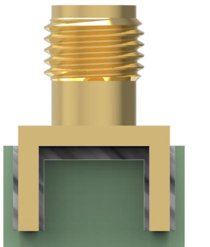
Abbildung 28 Spalt mit Lotpaste auffüllen
