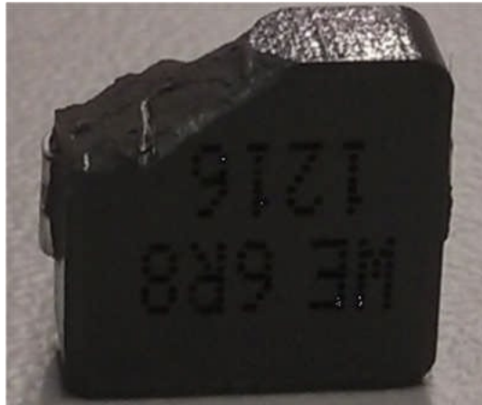
Abbildung 2: Abgebrochene Kante an WE-LHMI 74437368068 .
