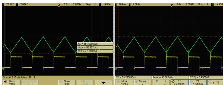
Abbildung 3: Verlauf des Spulenstroms und der Spannung mit der Induktivität ohne optische Mängel (linke Seite) und mit 15%ige Absplitterung (rechte Seite)
