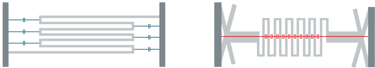
Abbildung 5: Die parasitären Kapazitäten von WE-CBF (links) und WE-CBF HF (rechts).
