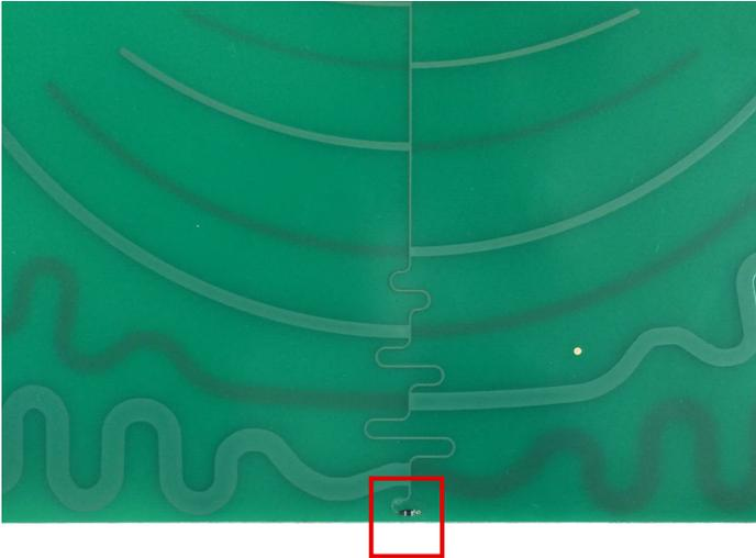
**Abbildung 22: PCB von LPDA mit WE-CBF HF (742862160)**
