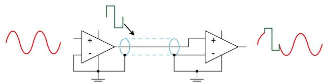
Abbildung 5: Einfluss von Störungen auf einen koaxialen Datenübertragungsweg
