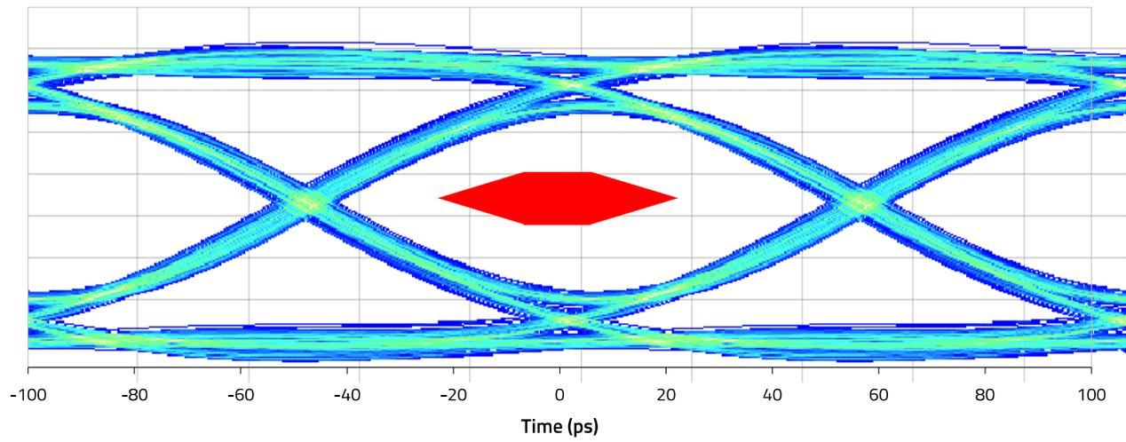
Abbildung 32: Augendiagramm des Filtersticks mit aktiviertem USB-Equalizer (@ 10 GBit/s)
