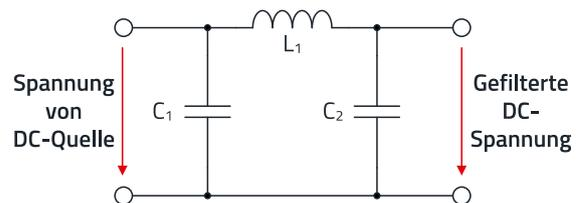
Abbildung 10:  $\pi$ -Filter-Topologie
