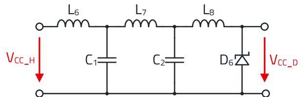
Abbildung 23: Implementierte SMD-Ferrite, π-Filter und TVS-Diodentopologie für 100 W Leistung
