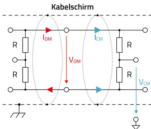
Abbildung 3: Die symmetrische Schnittstelle mit ihren messbaren Störspannungen
