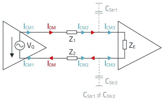
Abbildung 4: Umwandlung der Gegentaktstörung ( $I_{DM}$ ) in eine Gleichtaktstörung ( $I_{CM}$ ) aufgrund von parasitären Kopplungskapazitäten ( $C_{Str}$ ) in dem einen Kanal eines differentiellen Paares
