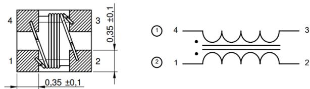
Abbildung 25: WE-CNSW HF ([744 233 56 00](#)) für den Datenleitungsfilter
