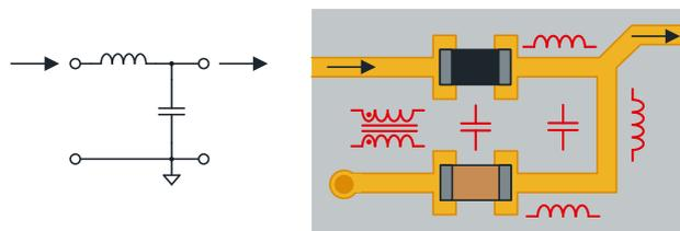
Abbildung 28: Beispiel eines Tiefpassfilters für hohe Frequenzen mit ungünstigem Layout
