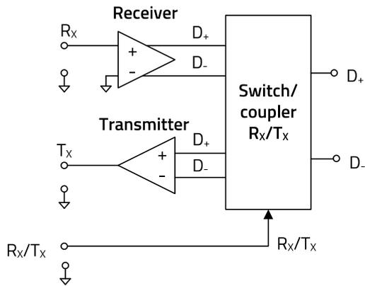
Abbildung 2: Die USB-Schnittstelle ist symmetrisch und bidirektional
