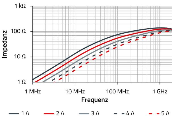
Abbildung 22: Komplexe Impedanzkurve und der Einfluss von Gleichstrom auf die Impedanz des WE-MPSB SMD Ferrits
