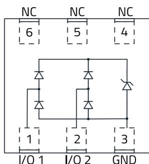
Abbildung 27: Elektrischer Schaltplan und Aufbau des Diodenarray WE-TV5 (824 012 823)
