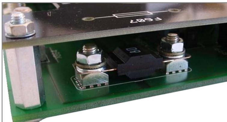
Möglichkeit zur Anbringung einer Sicherung
