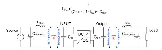
Abbildung 7: Darstellung der Ein-& Ausgangs Beschaltung für die Filterung von Gegentaktstörern
