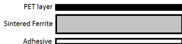
Abbildung 2: Aufbau der WE-FSFS-Folie
