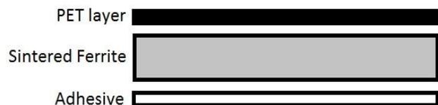
Abbildung 2: Aufbau der WE-FSFS-Folie
